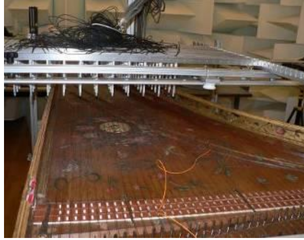
FIGURE 6.1 – Dispositif expérimental d'holographie acoustique en champ proche
