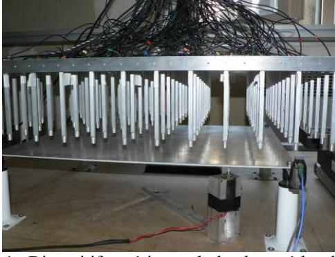
Figure 1 : Dispositif expérimental : la plaque à bords libre, le marteau automatique et l'antenne de 120 microphones
